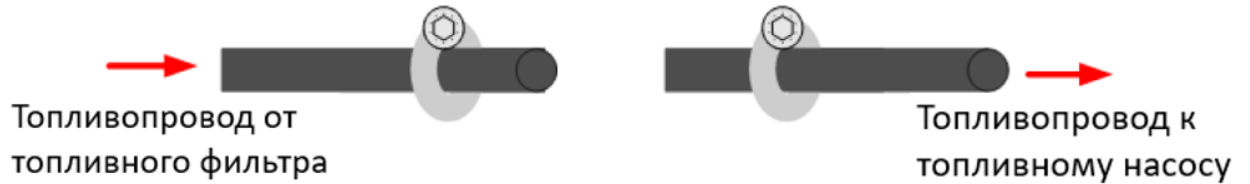
Рис. 5. Крепёжные хомуты надеваются на топливопровод
