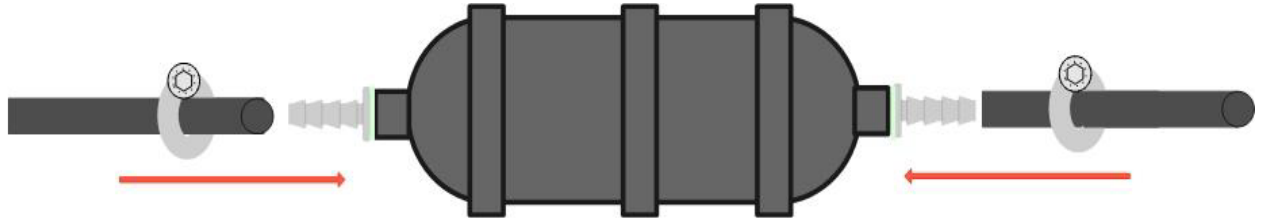
Рис. 8. Соедините концы топливного шланга с SGI-фильтром
